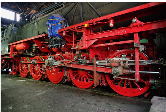
Blick auf das frisch revidierte Fahrwerk der Lok.
